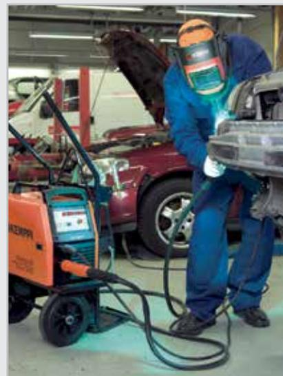
Ideale MIG/MAG-Impulsschweißlösung für Blechbearbeitung und Kfz-Reparaturen.
