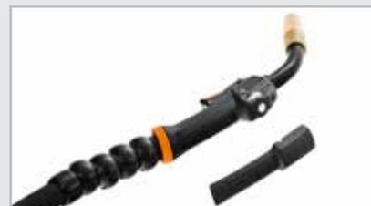
Bei Anschluss an Kemppi FastMig-Geräte ist die SuperSnake mit der GXR10 Gun Remote Brennerfernregelung kompatibel. So ist Leistungssteuerung in Echtzeit oder Kanalwahl im Fernzugriff einfach und bequem.
