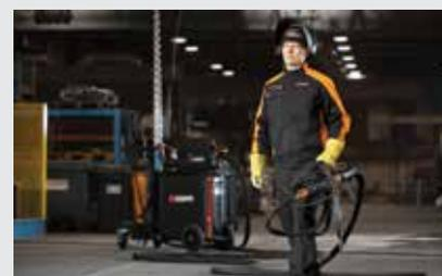
Das leichte Zwischenvorschubgerät ist eine ergonomische Alternative zu schweren und großen Drahtvorschubgeräten oder das Schweißen mit schweren Push/Pull-Schweißbrennern, die das Handgelenk des Schweißers stärker belasten.
