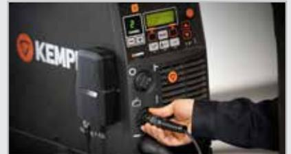
Das Digital Connectivity Module (DCM) ist mit der FastMig (einschließlich X5 FastMig) und den neuen MasterTig-Produktfamilien von Kempfi standardmäßig kompatibel. Für alle anderen Schweißmaschinenmodelle oder -marken werden die WeldEye-Adapter verwendet. Der X8 MIG Welder ist ab Werk mit einem Verbindungsmodul für WeldEye ausgestattet, sodass keine zusätzlichen Geräte benötigt werden.
