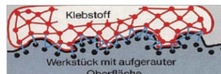
Durch Aufrauen der Werkstoffoberfläche wird die Kontaktfläche für den Klebstoff vergrößert.
