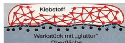
Je flüssiger der Klebstoff, um so leichter ist die Benetzung der Werkstückoberfläche.
