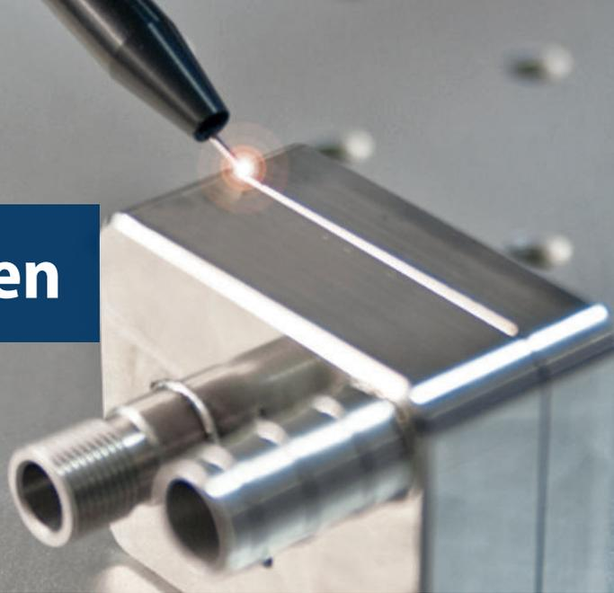
Der Einsatzbereich liegt in der Instandsetzung von Formen und Werkzeugen sowie deren Anpassung an neue Geometrien. Ebenso können im Bereich der mechanischen Fertigung Produktions- und Maßfehler korrigiert werden.
